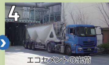
乾燥させた焼却灰に石灰石等を加えて、ロータリーキルン(焼成炉)にて1350℃以上で焼いた後、石こう等を加えて粉砕するとエコセメントが完成します。(写真:東京たま広域資源循環組合)
