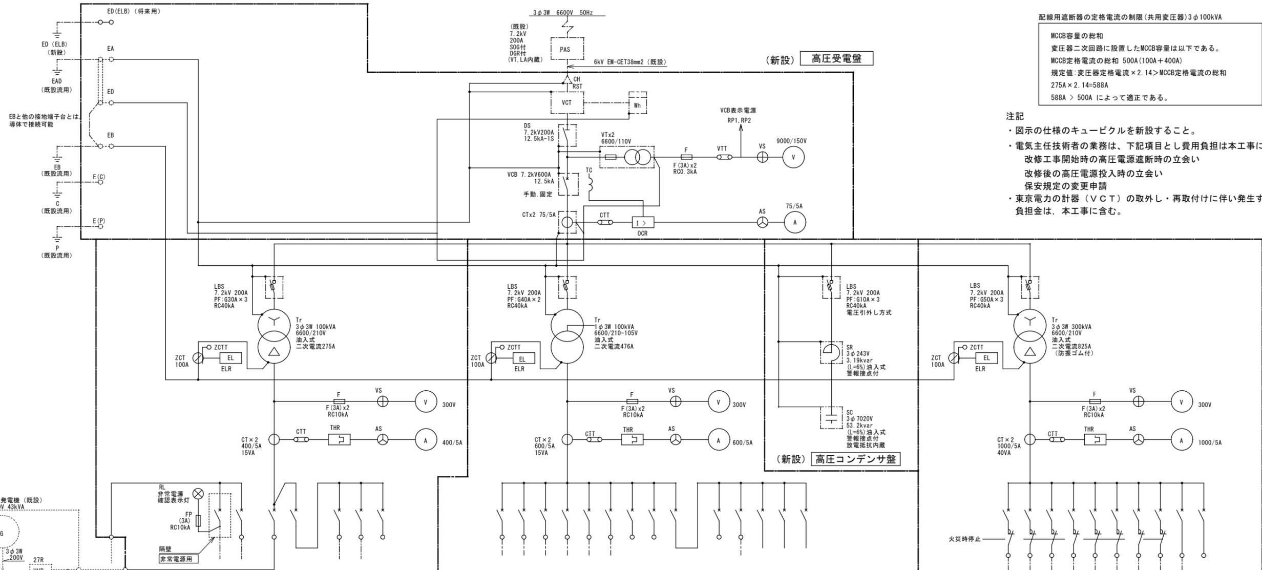
配線用遮断器の定格電流の制限 (共用変圧器) 3φ 100kVA
