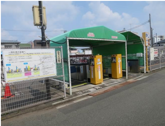
図 17 ゲート式システムの例 (調布市立西調布南第1自転車等駐車場)
