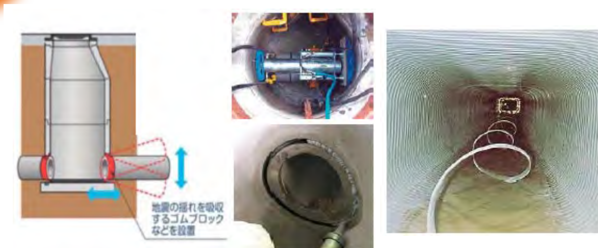
既設マンホールと管渠の接続部の可とう化
