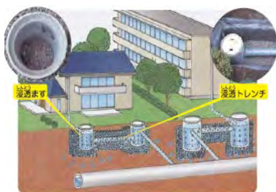
雨水浸透施設
