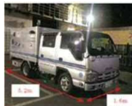
路面下空洞探査車
