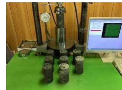
④地盤改良体の強度 (一軸圧縮強度試験)
