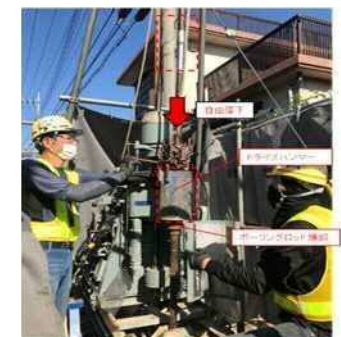
④地盤改良体の強度 (標準貫入試験)
