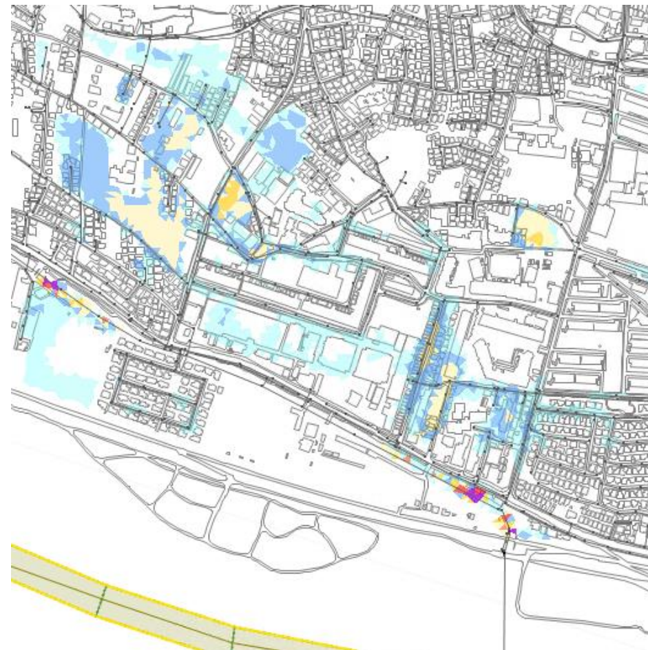
樋管操作で逆流を抑制した場合
