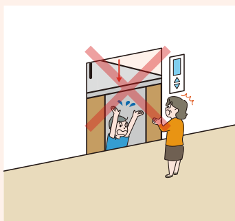
◎戸開走行保護装置
