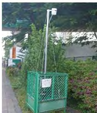
大気質（粉じん等）測定状況
