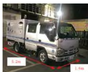
路面下空洞探査車
