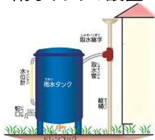
雨水タンクの設置
